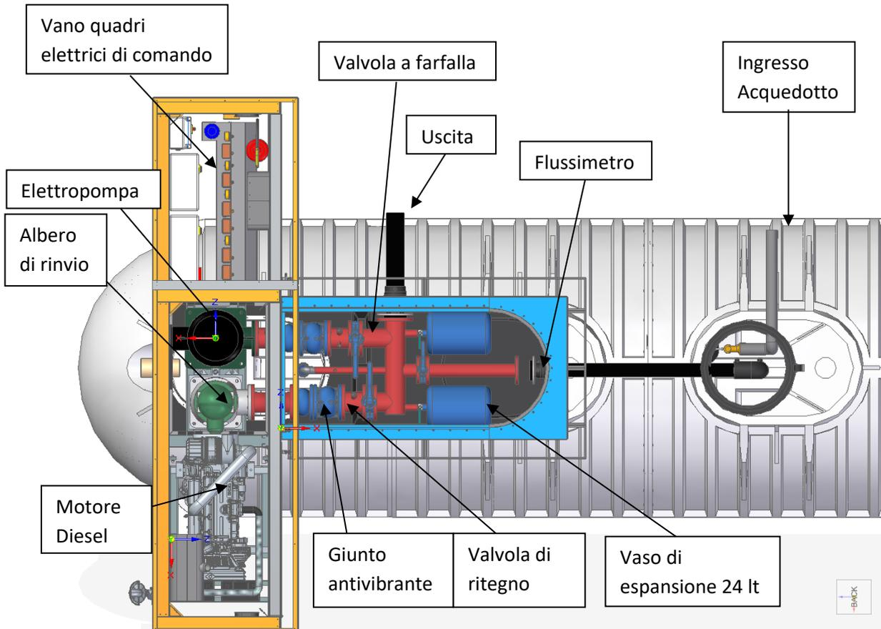
**Pozzetto piping e valvole di regolazione da interro, realizzato di polietilene e rinforzato con struttura in acciaio, coperchio pedonabile in acciaio coibentato REI 60 completo di:**
